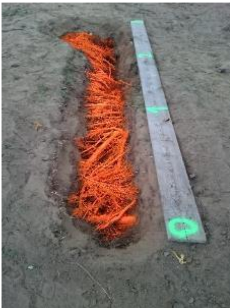
Wurzelsuchgraben mit markierten Wurzeln (Beispiel) Foto erstellt durch Eckhard Zemke
