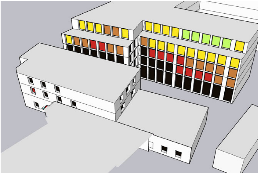
Abbildung 7.10: Besonnung Umgebung Süd, Ist-Zustand am 21. Dezember
