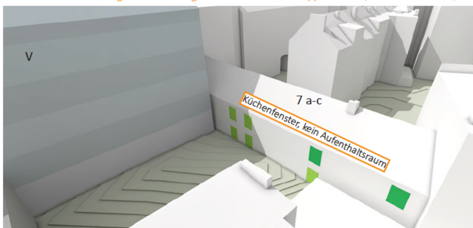
Abb. 12: Besonnungszeiten nach DIN EN 17037, Simulation einer maximal möglichen Bebauung nach B-Plan-Entwurf Eppendorf 3 am 20. März, Goernestraße 7a-c (Eigene Darstellung. Digitales 3D-Gelände- und Gebäudemodell: Modellgrundlage: FHH, LGV, LOD3 Stand: 2023/ DGM10H Stand: 2021, STUDIO HONIG, Stand: April 2025 und B-Plan-Entwurf Eppendorf 3, Stand: April 2025)
