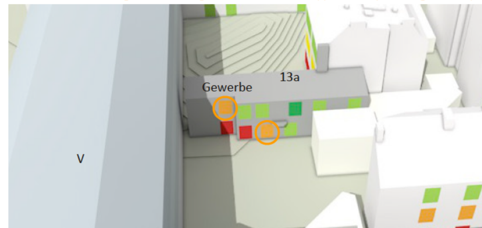
Abb. 17: Besonnungszeiten nach DIN EN 17037, Simulation einer maximal mögliche Bebauung nach B-Plan-Entwurf Eppendorf 3 mit Goernestr. 13a am 20. März, Goernestraße 13a (Eigene Darstellung. Digitales 3D-Gelände- und Gebäudemodell: Modellgrundlage: FHH, LGV, LOD3 Stand: 2023/ DGM10H Stand: 2021, STUDIO HONIG, Stand: April 2025 und B-Plan-Entwurf Eppendorf 3, Stand: April 2025)
