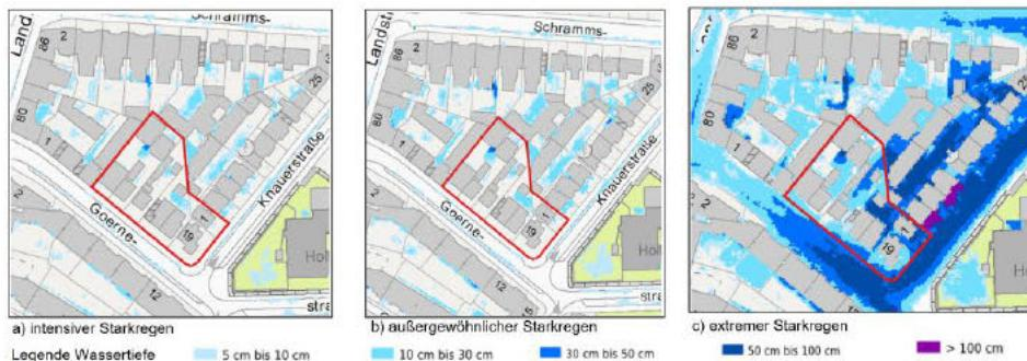
Abbildung 3: Darstellung des Überflutungsgefahrenpotenzials infolge eines Starkregenereignisses [22] überarbeitet
