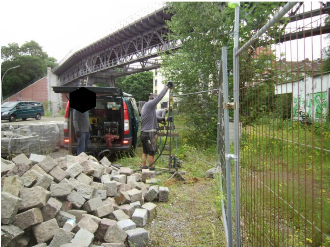
**Foto 2** RKS 13 im südwestlichen Teil der Untersuchungsbereichs, der zurzeit als Baumaterial-Lagerfläche genutzt wird. Er ist an der Oberfläche teilweise mit Verbundsteinen befestigt und weist asphalthaltigen Füllboden auf.
