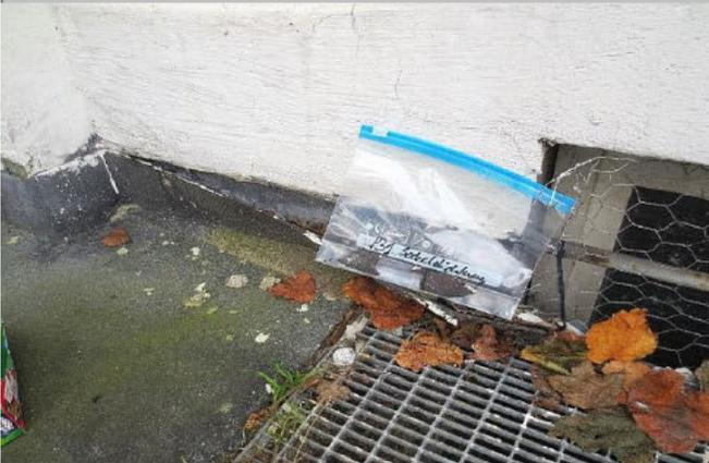
EG, Außenwand, Sockeldichtung, Dichtbahn (Probe P 31: Asbest n.n., S PAK 11,6 mg/kg TS, Hg < 1 mg/kg TS)
