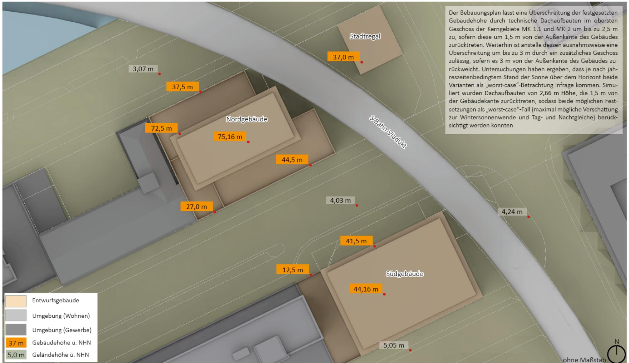
Abb. 29: Modellhöhenplan - Gebäudehöhen entsprechend den maximal möglichen Höhen gem. Bebauungsplan-Vorentwurf Hammerbrook 15 (Eigene Darstellung. Digitales 3D-Gelände- und Gebäudemodell: FHH, LGV, LOD2 Stand: Frühjahr 2021/ DGM5H Stand: Frühjahr 2020)
