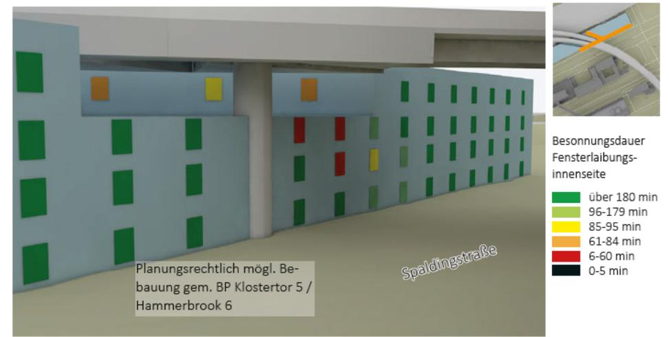
Abb. 49: Bestandssimulation Besonnung mögliche Bebauung BP KT5/HB6 Südfassaden (Eigene Darstellung. Modellgrundlage: FHH, LGV, LOD2 Stand: Frühjahr 2021/ DGM5H Stand: Frühjahr 2020)
