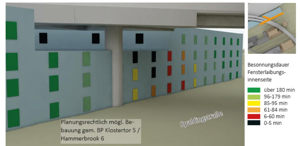
Abb. 52: Entwurfssimulation Besonnung mögliche Bebauung BP KT5/HB6 Südfassaden (Eigene Darstellung. Modellgrundlage: FHH, LGV, LOD2 Stand: Frühjahr 2021/ DGM5H Stand: Frühjahr 2020)
