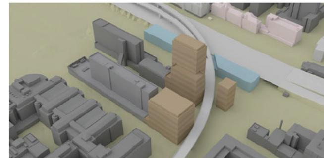
Abb. 35: Bestandsbebauung und maximale Kubatur nach Bebauungsplanentwurf, Blickrichtung nach Nordwesten (Eigene Darstellung. Entwurfsgebäude gem. Bebauungsplan-Vorentwurf Hammerbrook 15, Stand: 31.05.2023, Digitales 3D-Gelände- und Gebäudemodell: FHH, LGV, LOD2 Stand: Frühjahr 2021/ DGM5H Stand: Frühjahr 2020)
