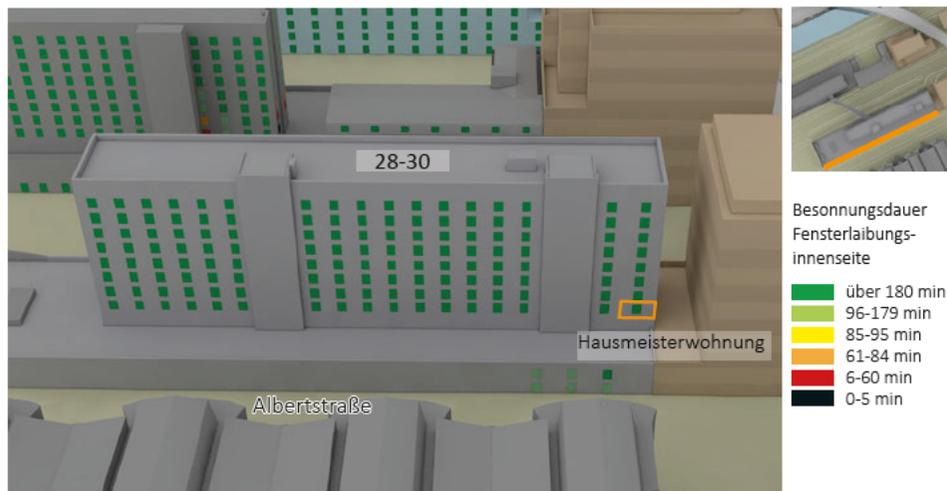
Abb. 46: Entwurfssimulation Besonnung Nordkanalstraße 28-30 Südfassaden (Eigene Darstellung. Modellgrundlage: FHH, LGV, LOD2 Stand: Frühjahr 2021/ DGM5H Stand: Frühjahr 2020)
