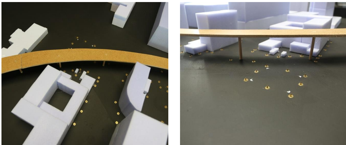
Abb. 2.6: Windkanalmodell im Istzustand – Geschwindigkeitsmessungen mit Irwinsonden (WI, 2023)
