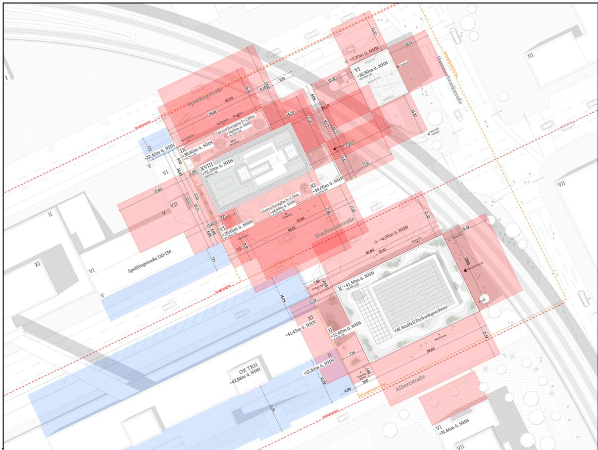
Abbildung 1: Abstandsflächen nach Regelmäß von 0,4 H (Jan Wiese Architekten GmbH, Stand August 2024)
