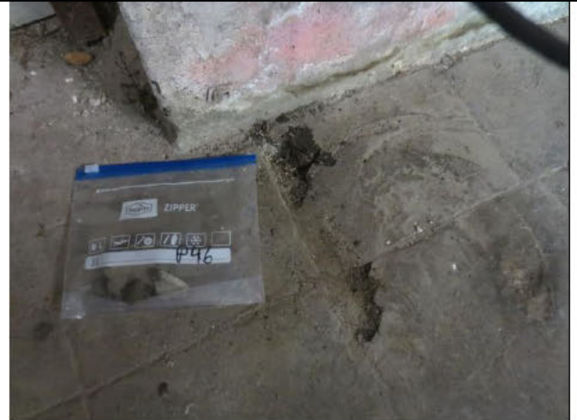
Nr. 140, altes UG: Bodenfliese → P 46
