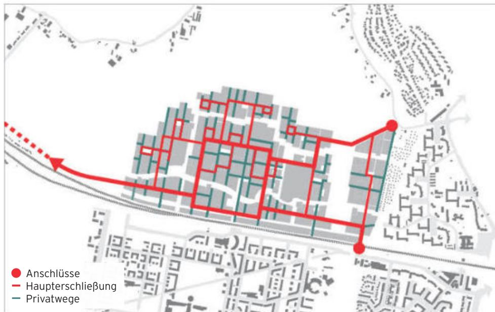
Differenziertes Straßennetz im Stadtteil mit drei Anschlüssen
