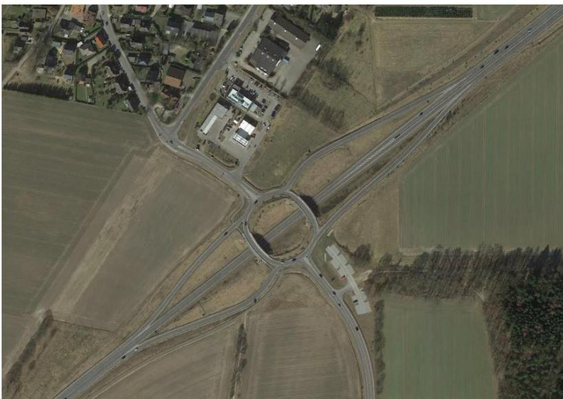
Abbildung 22: Anbindung aller Fahrbeziehungen an großem Kreisverkehr bei Buchholz in der Nordheide (B75/Dibberser Straße) (Quelle: Google Earth)
