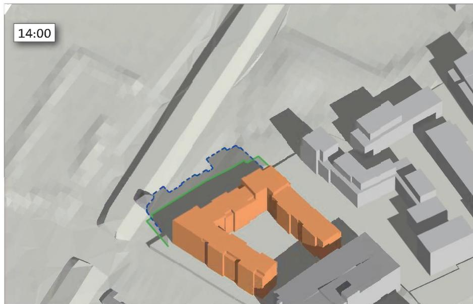
Abb. 100: Überlagerung Schattenwurf Planrechtsvariante - Entwurfsvariante 14 Uhr 20. März
