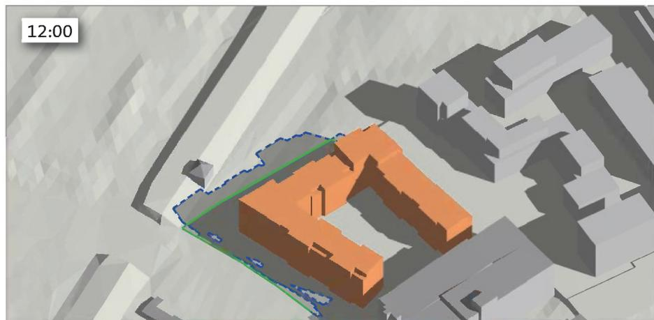
Abb. 18: Überlagerung Schattenwurf Planrechtsvariante - Entwurfsvariante 12 Uhr 20. März
