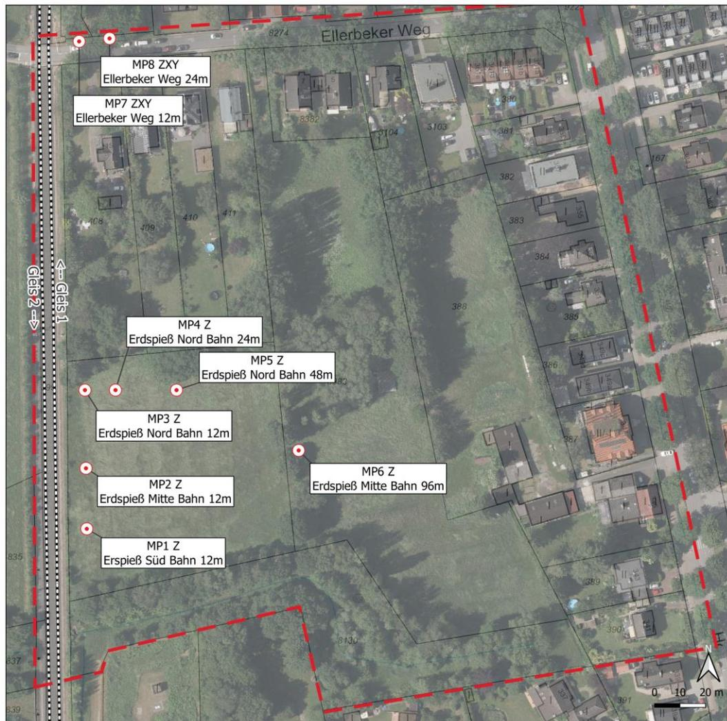
Abbildung 3: Luftbild des Plangebiets mit der AKN-Bahnstrecke und den Messpunkten mit der Angabe des Abstands zur nächstgelegenen Gleisachse (Plangrundlage Freie- und Hansestadt Hamburg, Landesamt für Geoinformation und Vermessung)
