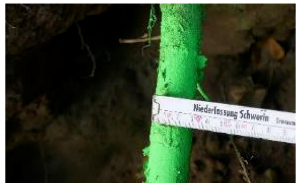
Wurzel mit 3 cm Ø
