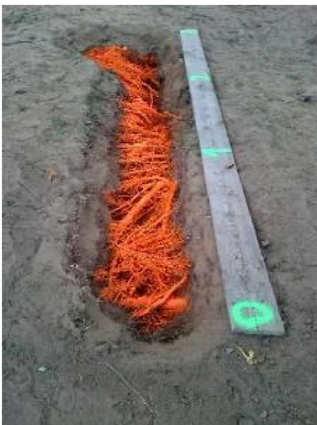
Wurzelsuchgraben mit markierten Wurzeln (Beispiel)
