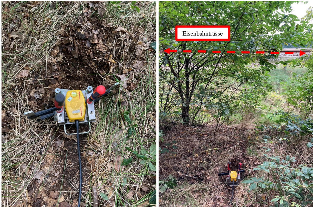
Abbildung A3: Messpunkt 1 auf Erdspeiß (Quelle: Wölfel Engineering GmbH + Co. KG)
