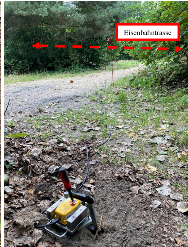
Abbildung A7: Messpunkt 5 auf Erdspeiß (Quelle: Wölfel Engineering GmbH + Co. KG)
