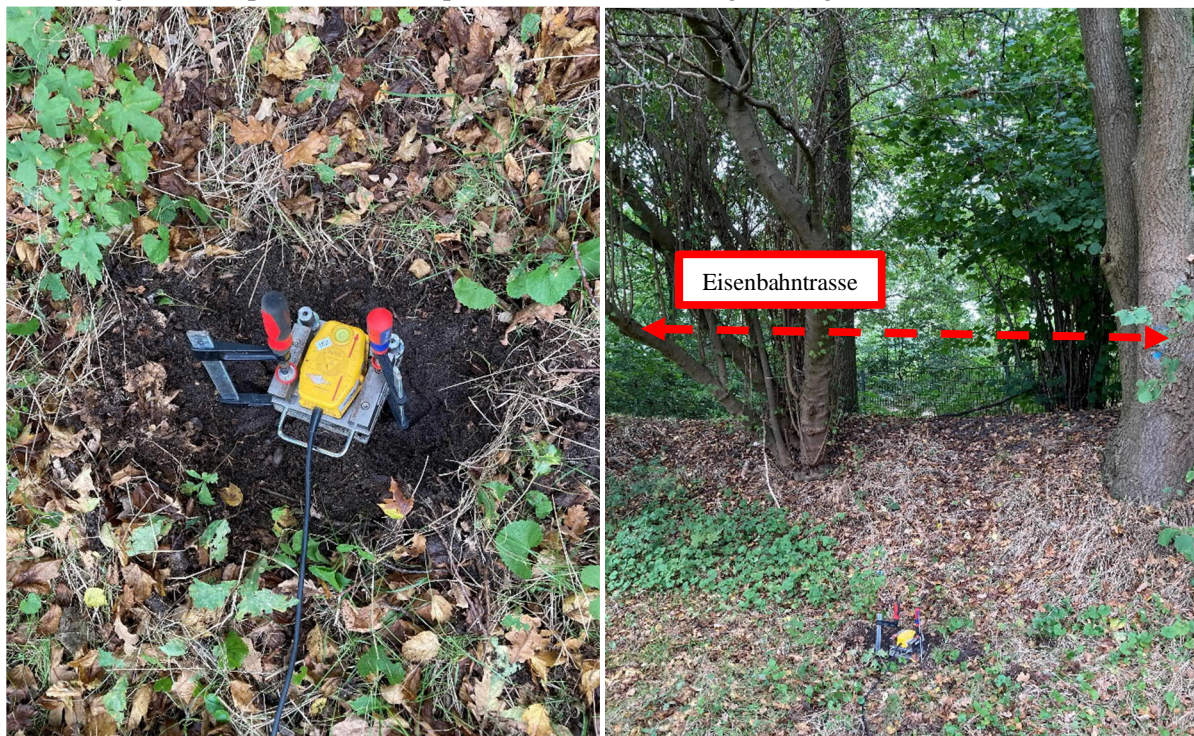
Abbildung A4: Messpunkt 2 auf Erdspeiß (Quelle: Wölfel Engineering GmbH + Co. KG)
