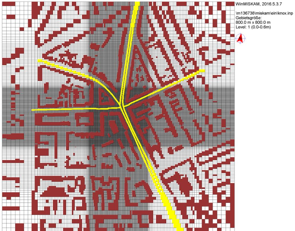
Abbildung 11. Rechengitter des MISKAM-Rechengebietes. Gebäude sind durch rotbraun-, Emissionsquellen durch gelb-gefärbte Rasterflächen markiert.
