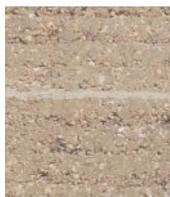
Lehm kann auf innovative Weise als Außenfassade eingesetzt werden, zum Beispiel als Stampflehmfertigteil mit innenliegender Kerndämmung. Eine Kombination mit einer Holz- oder Betonskelettbauweise ist sinnvoll.
