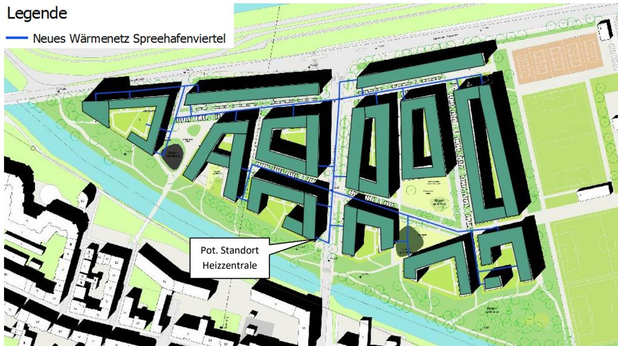
Abbildung 7: Trassenplanung für das Wärmenetz Spreehafenviertel
