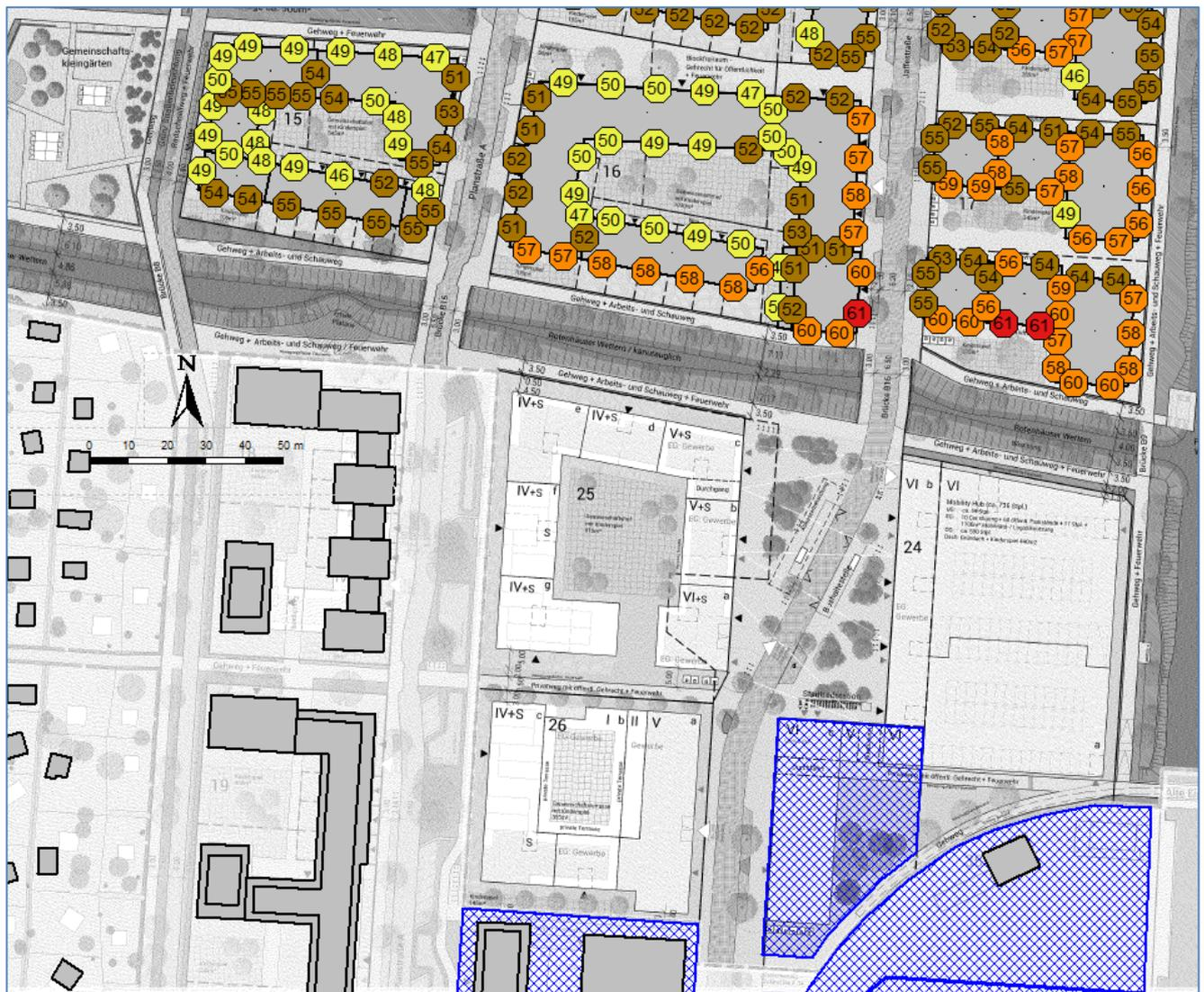
Abbildung 10. Teil-Variante 1: Keines der Baufelder BF 24 bis BF 26 bebaut: Beurteilungspegel der gewerblichen Geräuschimmissionen nachts, im lautesten Geschoss, in dB(A).
