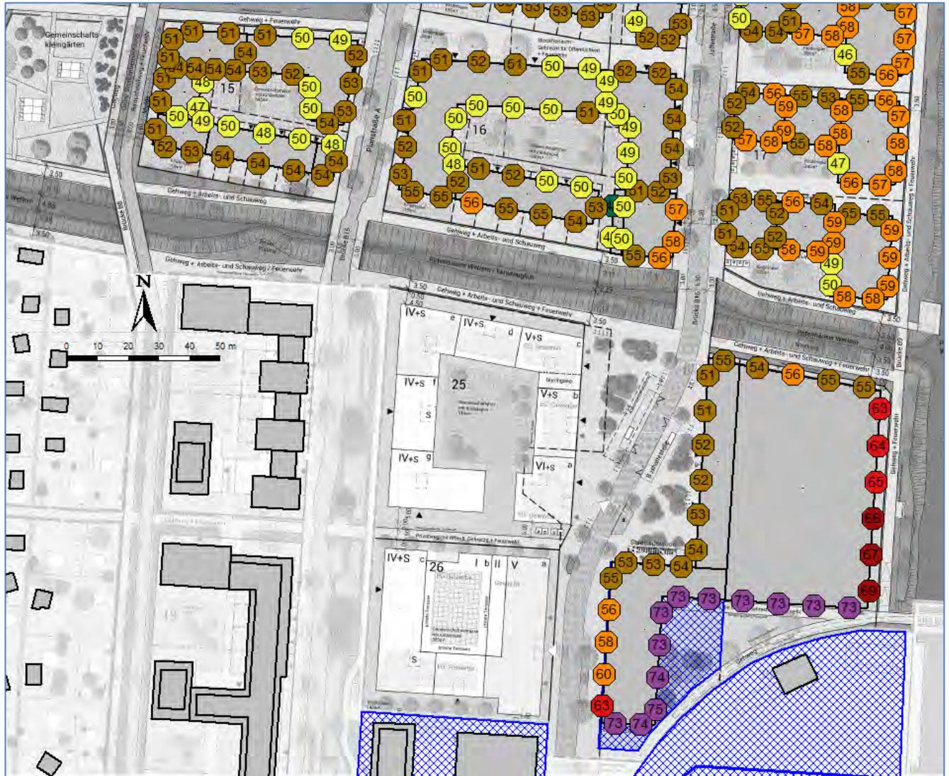
Abbildung 11. Teil-Variante 2: Baufeld BF 24 vollständige bebaut, Baufelder BF 25 + BF 26 ohne Bebauung: Beurteilungspegel der gewerblichen Geräuschimmissionen tags, im lautesten Geschoss, in dB(A).
