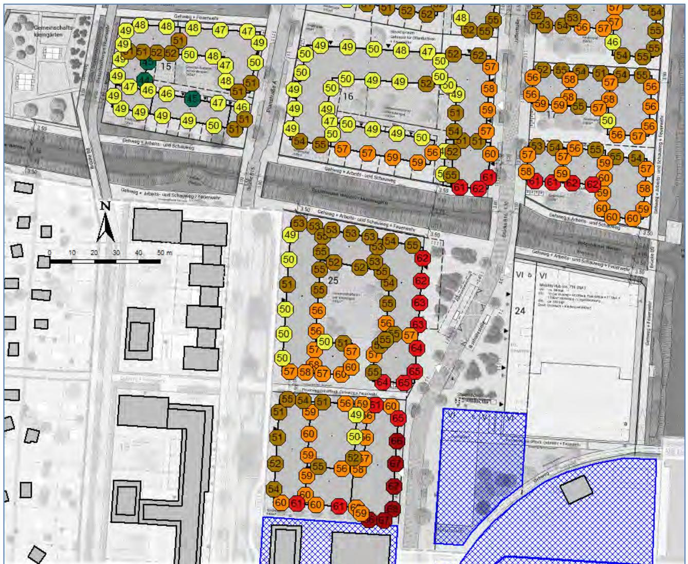
Abbildung 14. Teil-Variante 3: Baufelder BF 25 + BF 26 vollständige bebaut, Baufeld BF 24 ohne Baukörper: Beurteilungspegel der gewerblichen Geräuschimmissionen nachts, im lautesten Geschoss, in dB(A).
