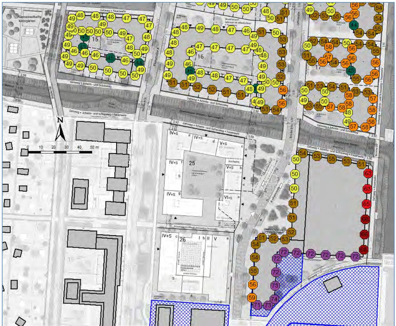
Abbildung 12. Teil-Variante 2: Baufeld BF 24 vollständige bebaut, Baufelder BF 25 + BF 26 ohne Bebauung: Beurteilungspegel der gewerblichen Geräuschimmissionen nachts, im lautesten Geschoss, in dB(A).
