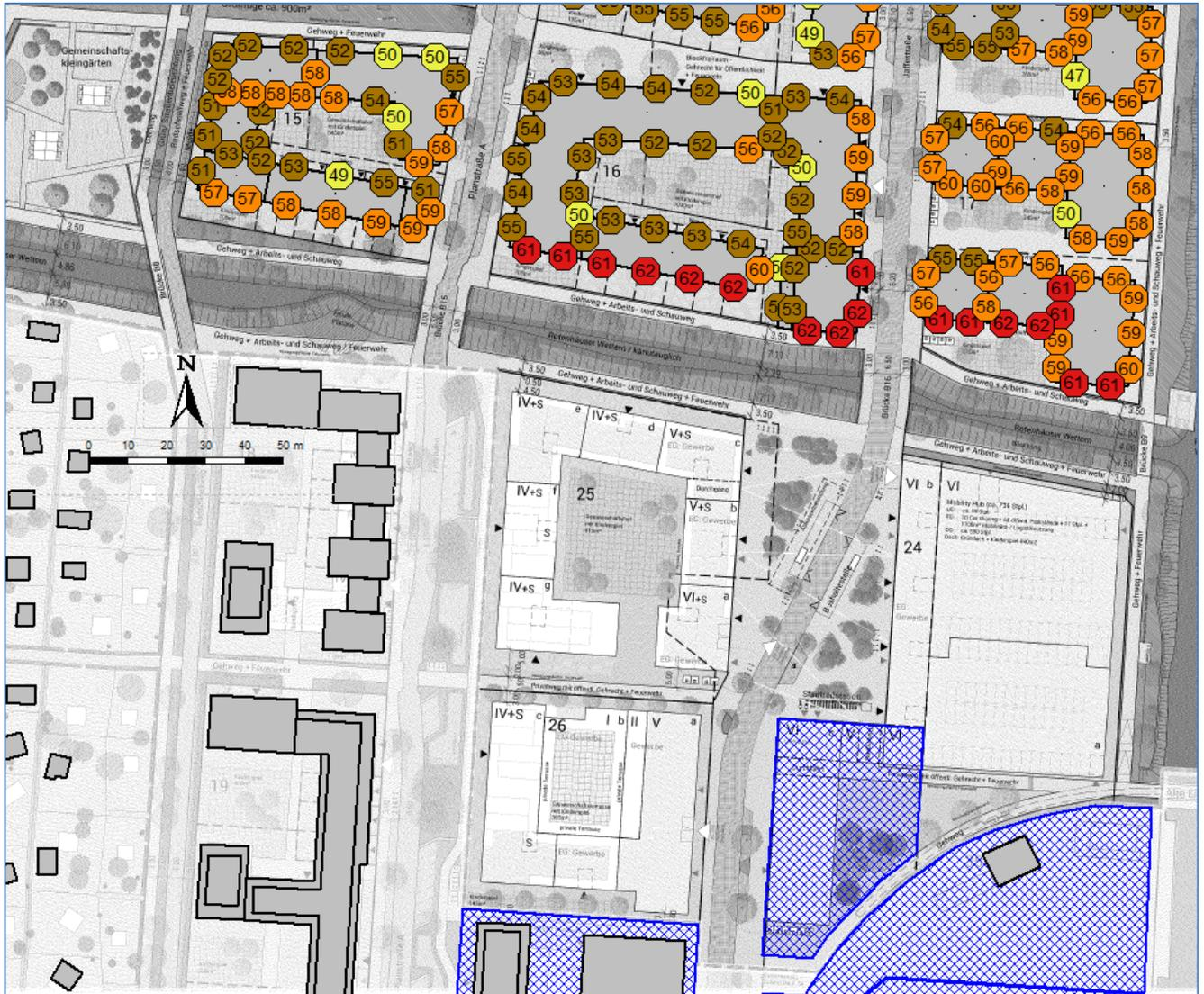
Abbildung 9. Teil-Variante 1: Keines der Baufelder BF 24 bis BF 26 bebaut: Beurteilungspegel der gewerblichen Geräuschimmissionen tags, im lautesten Geschoss, in dB(A).
