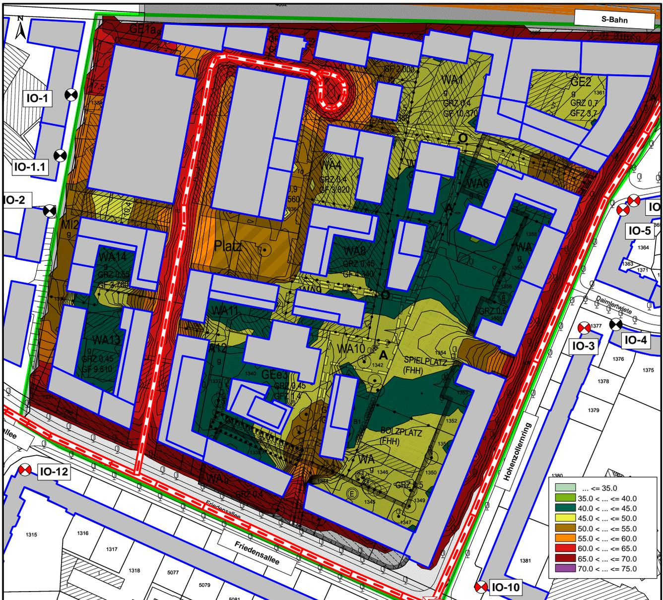
Abbildung 7. Beurteilungspegel aus Verkehrslärm, tags in dB(A), ebenerdige Außenwohnbereiche (2 m über Gelände), Maßstab 1 : 2.000.
